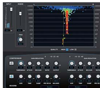
画面3 スネアのタイミングでパッと点灯する部分を囲んだら、下段左側の枠内に対して効果がかかる方のリバーブをONにしてパラメーターを設定していく
