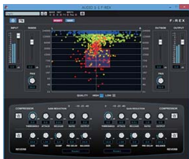
画面1 画面中央のカラフルな部分がハーモニックビューだ。音を音、定位、帯域、レベルに応じた位置と色で視覚的に表示し、その一部をマウスで囲むことで編集対象に設定する
